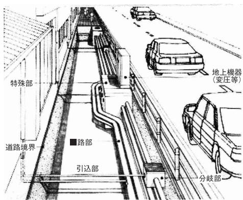
電線共同溝のイメージ図
